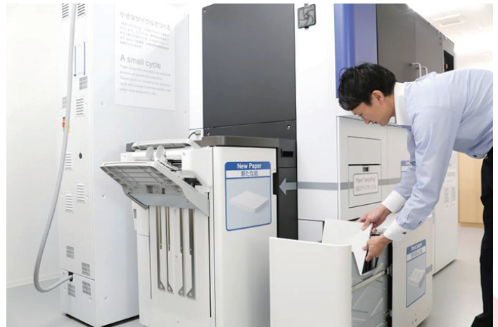
「PaperLab A-8000」に使用済みの紙をセット。 3分後には新しい再生紙が生まれる（エル・ローズ社内）
